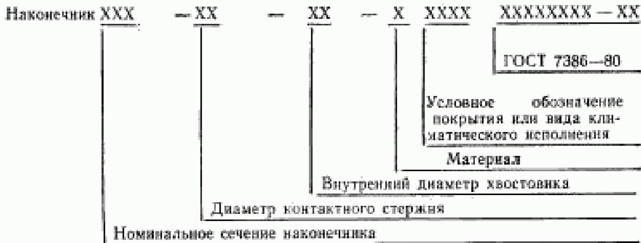
Пример условного обозначения наконечника глухого номинальным сечением 70 мм<sup>2</sup>, с отверстием под контактный стержень диаметром 12 мм, с внутренним диаметром хвостовика 13 мм, изготовленного из меди, без покрытия, климатического исполнения УХЛЗ.
